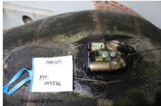
Figure 4 : Différentes étapes de la fixation d'une balise de type Splash sur une tortue caouanne
