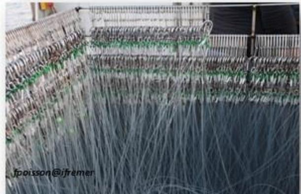
Figure 20 : Eléments d'une palangre semi-automatique : Enrouleur à entrainement hydraulique et avançons équipés d'agrafes stockés dans une caisse de rangement
