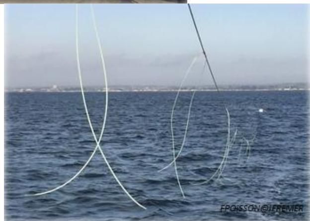
Figure 69. Ligne d'effarouchement construite par les étudiants du Lycée de la mer avec du matériel offert gracieusement par la société Seabird 100m de lignes d'effarouchement. (Tube photoluminescent – diamètre  $5\pm 0,2 \times 3,4\pm 0,2$  en PEHD).
